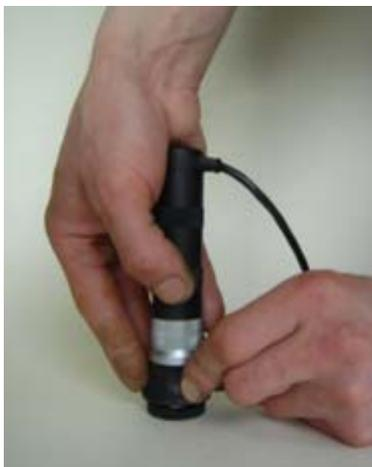
7.4.1.6. Дождавшись звукового сигнала и появления на индикаторе вместо символов **><** измеренного значения твердости, плавно прекратить прикладывать усилие к корпусу датчика.
