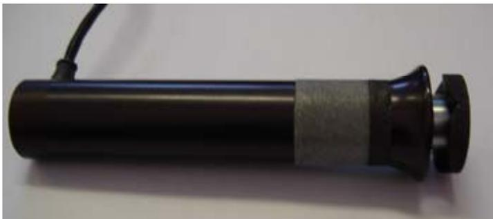
*Рисунок 7.4.1.1.1 Вид ультразвукового датчика с насадкой*
