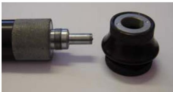
*Рисунок 7.4.1.1.2. Вид ультразвукового датчика без насадки*
