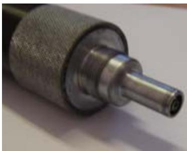
*Рисунок 7.4.1.1.5 Преобразователь со снятой насадкой*
